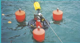
4.6. Recolhedor (*skimmer*) do tipo vertedouro. RO-CLEAN DESMI
