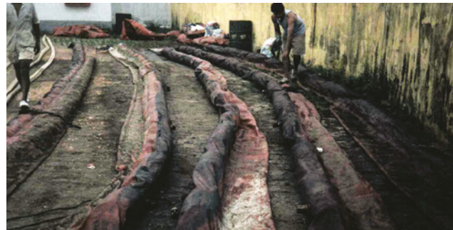
15.21. Lavagem de barreiras de contenção sujas de óleo. Banco de Imagens da CETESB.
