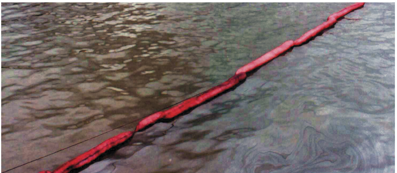
4.10. Aplicação de barreira absorvente em água com presença de mancha de óleo no aspecto prateado. Banco de imagens da CETESB
