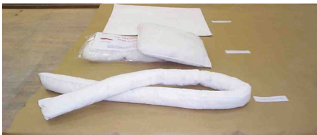
7.10. Cordões, almofadas e mantas absorventes de grande utilidade na remoção de empocamento de óleo. Banco de imagens da CETESB
