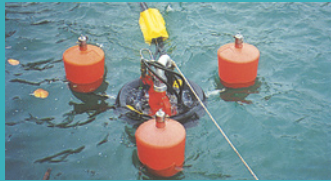
4.6. Recolhedor ( skimmer ) do tipo vertedouro. RO-CLEAN DESMI
