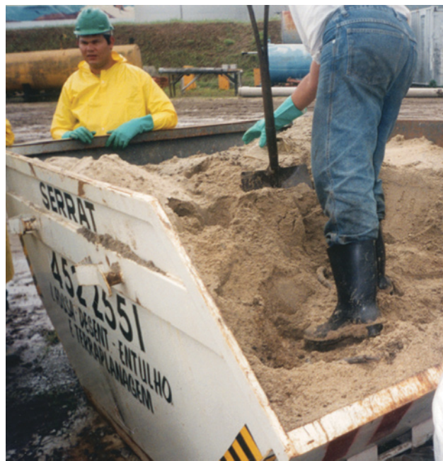
15.8. Triagem de areia levemente contaminada trazida em caçamba. Poffo, Iris/Banco de Imagens da CETESB.
