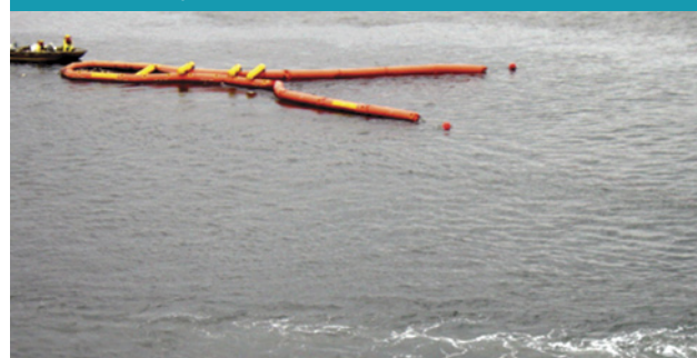
4.4. Barreiras apropriadas para recolhimento de óleo em lâminas tênues de aspecto iridescente a prateado (modelo current buster ). Banco de imagens da CETESB
