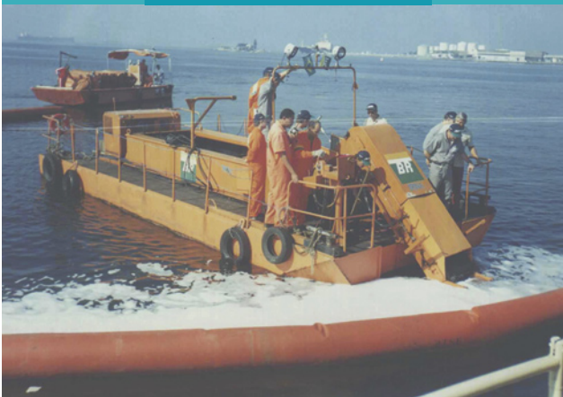
4.7. Barcaça recolhadora tipo Egmopol da Petrobras, em atividade durante exercício simulado. Banco de imagens da CETESB
