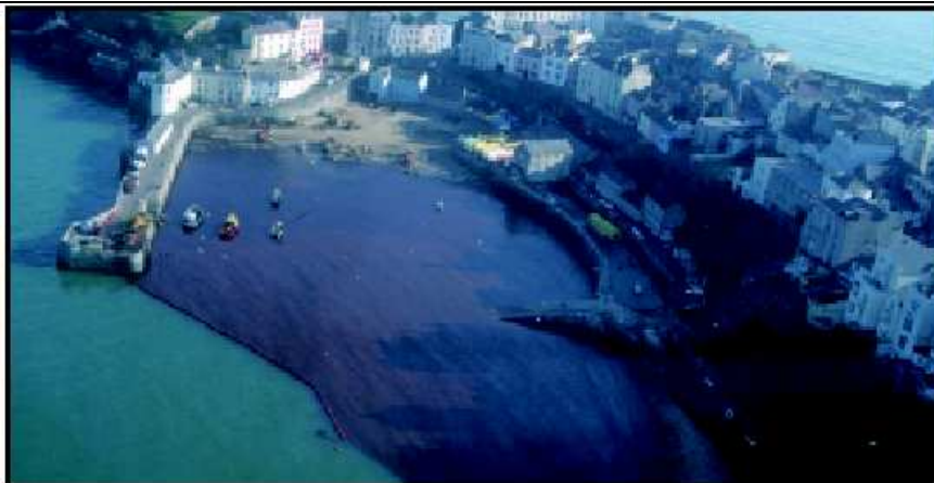
Figura 7: Área muito extensa de emulsão laranja/marrom, parcialmente retida no porto por uma seção de barreiras de contenção flutuantes.
