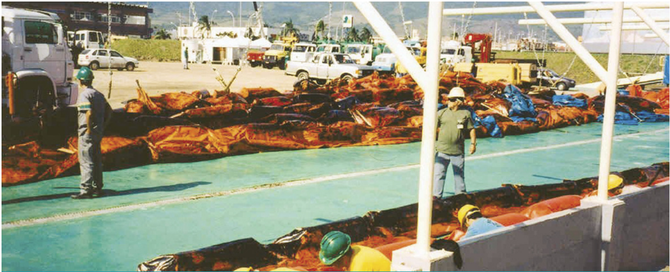
15.22. Lavagem de barreiras de contenção sujas de óleo. Banco de Imagens da CETESB
