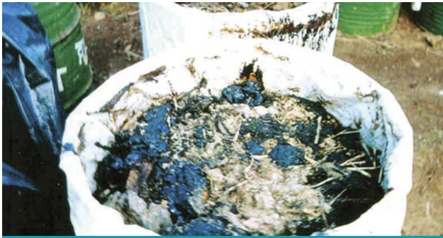
15.9. Areia contaminada segregada e acondicionada corretamente em tambor. Poffo, Iris /- Banco de Imagens da CETESB
