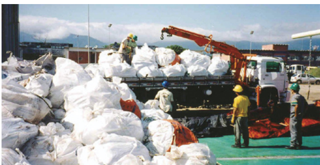
15.19. Descarregamento de resíduos em "big bags" por caminhão munck na instalação. Banco de Imagens da CETESB.
