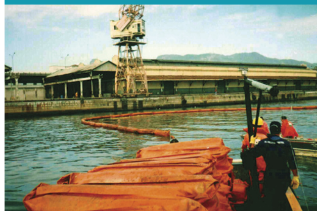
4.2. Barreira de cortina em detalhe. Banco de imagens da CETESB
