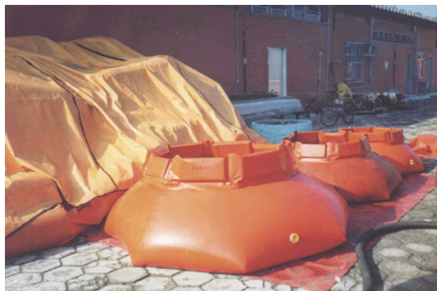
15.4. Tanques infláveis para acondicionamento de resíduo oleoso. Banco de Imagens da CETESB.
