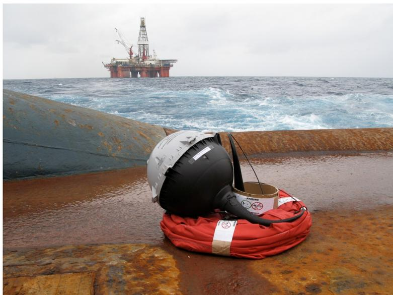
**Figura 3: O derivador SVP-IRIDIUM pronto para o lançamento.**
