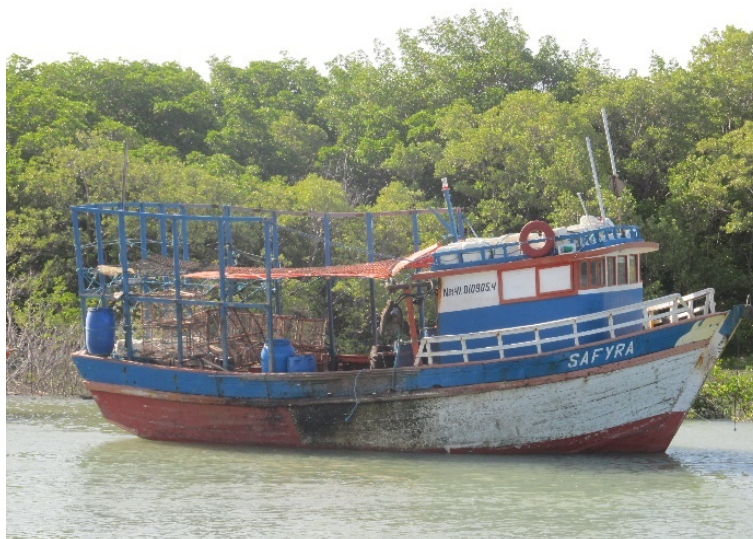
FIGURA II.5.3.8.1.6 – Embarcação industrial que opera na modalidade de manzuá direcionada à captura de lagosta no litoral norte do Brasil.
