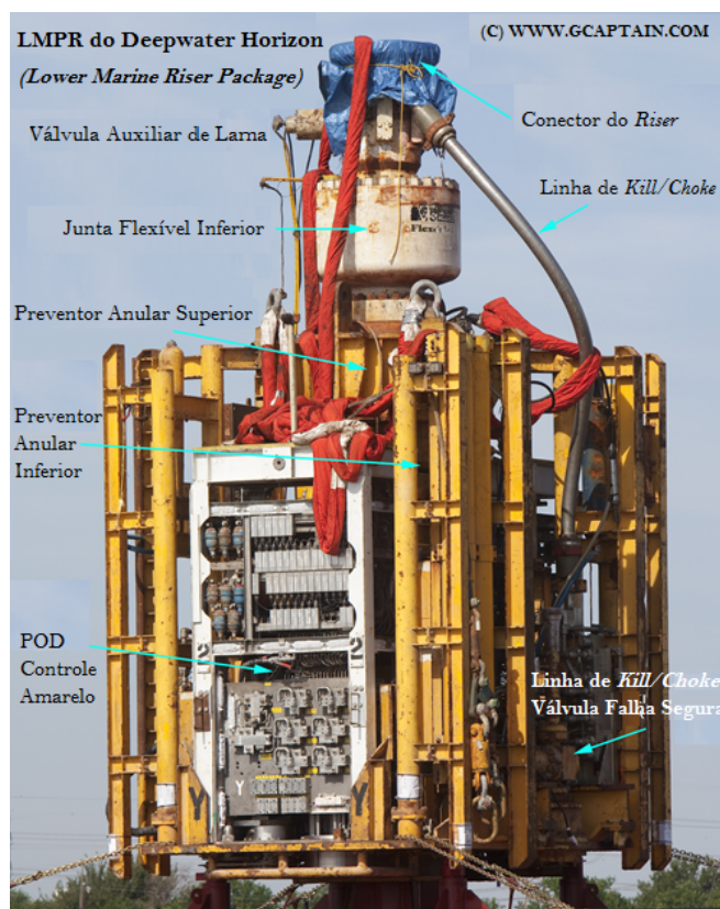
FIGURA II.3.1.6 – Arranjo típico de um conjunto de BOP.
