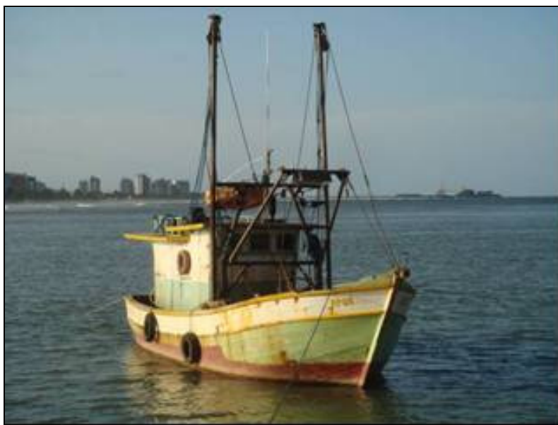
Figura II.5.3.N.6-5 – Barco de Convés médio com guincho para pesca de arrasto com porta sediado no Pontal – Ilhéus.
