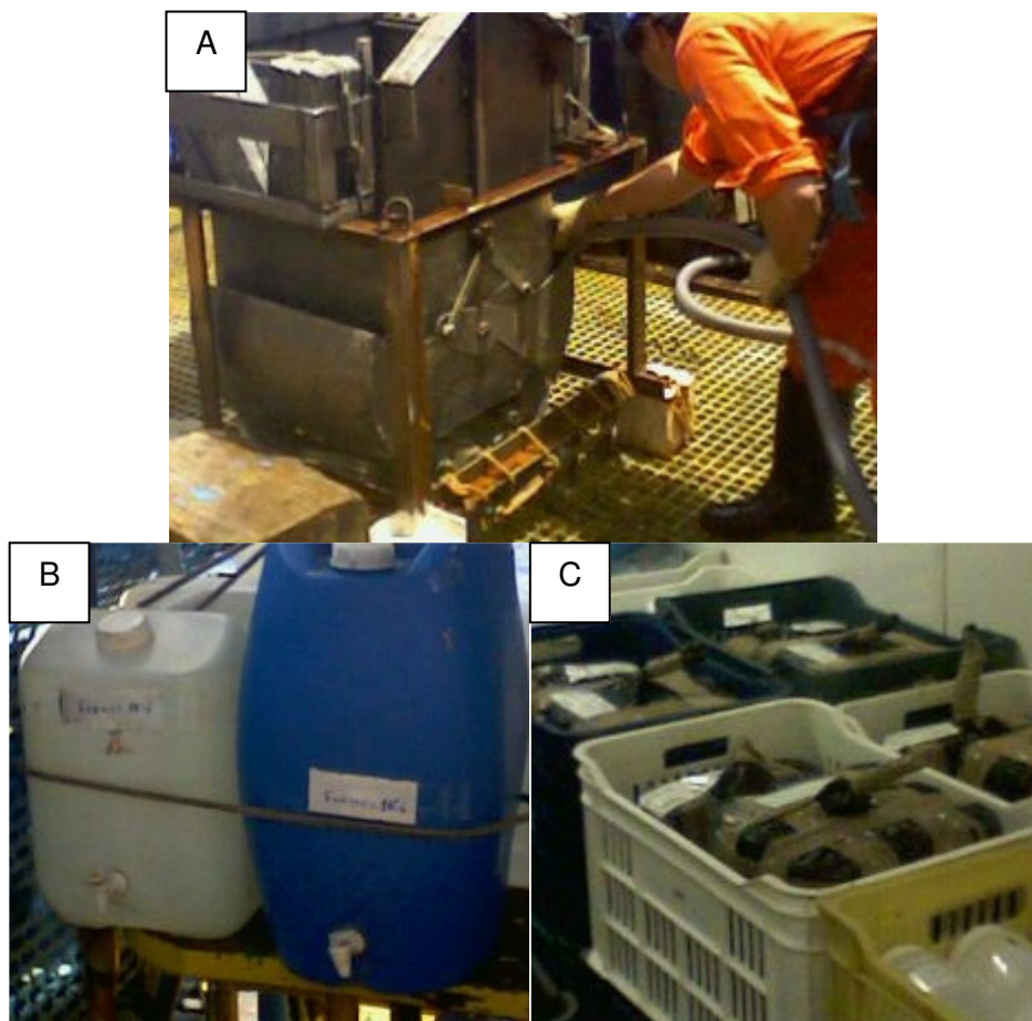
Figura II.5.2.D.1 - 6 – Infra-estrutura do navio Emma McCall: A – Box Corer, B - Bancada de formol diluído a 4%; C- Acondicionamento das amostras de zoobentos.
