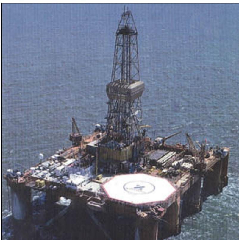
**Figura II.8.1.2-1** – Plataforma semi-submersível *SS-54 Ocean Winner*
