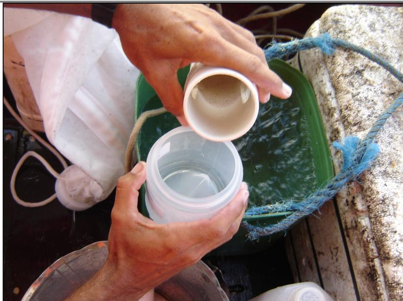
**Figura II.5.2.D.2-3**– Acondicionamento do material retido na rede de arrasto em potes plásticos.
