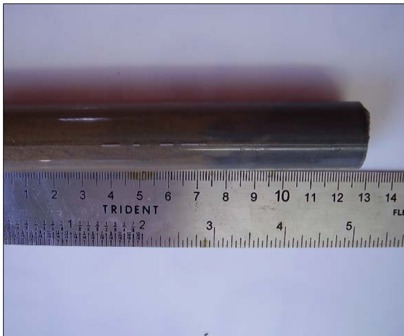
Figura II.5.1.4.2.1-12 - Medição da profundidade da camada anóxica.
