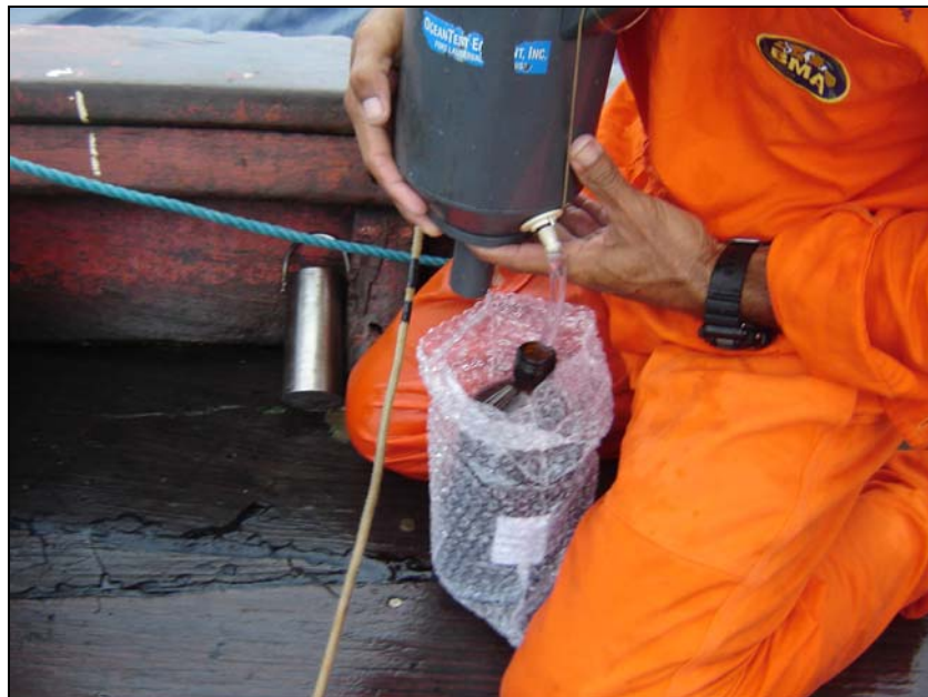
Figura II.5.1.4.2.1-3 - Transferência da amostra coletada com a garrafa Go-Flo para os frascos de acondicionamento.
