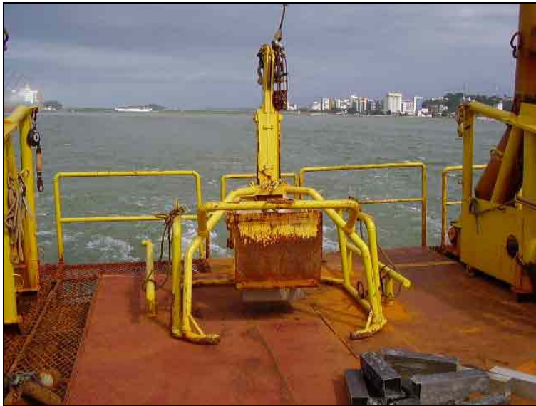
Figura II.5.1.4.2.1-6 - Draga Box-Corer utilizada na obtenção das amostras de sedimento para a caracterização da região do Bloco BM-J-1.
