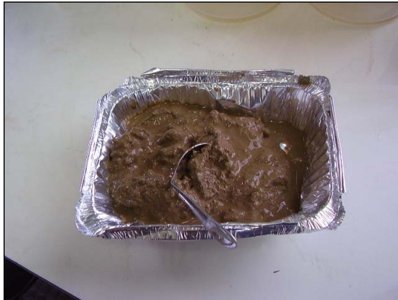
Figura II.5.1.4.2.1-13 - Acondicionamento de amostras para HPAs em vasilhames de alumínio.
