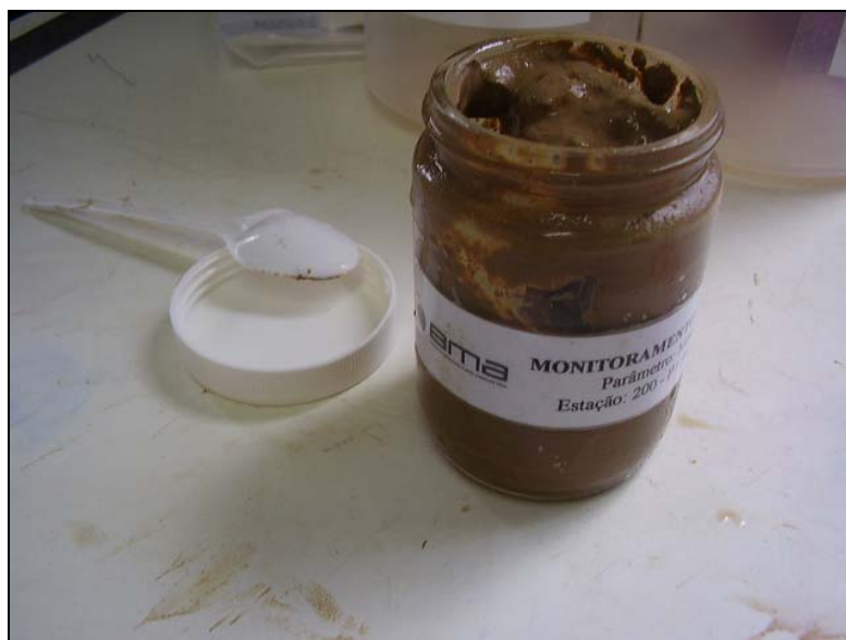
Figura II.5.1.4.2.1-14 - Acondicionamento de amostras para metais em vasilhames de vidro.
