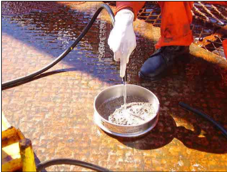
Figura II.5.1.4.2.1-11 - Drenagem da água retida na Box-Corer.
