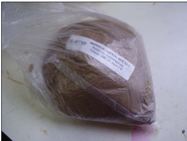
Figura II.5.1.4.2.1-15 - Acondicionamento de amostras para sedimentologia em sacos plásticos.
