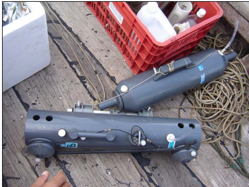
Figura II.5.1.4.2.1-2 - Garrafas Go-Flo e Niskin utilizadas durante a coleta de água nas estações de amostragem do Bloco BM-J-1.
