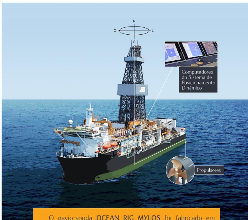
O navio-sonda OCEAN RIG MYLOS foi fabricado em 2013, tem capacidade para operar sobre uma coluna d'água de até 3.000 m de profundidade e perfurar poços de até 12.192 m de comprimento.
