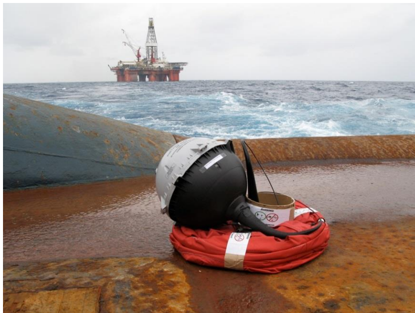
Figura 3: Derivador WOCE-SVP pronto para o lançamento.
