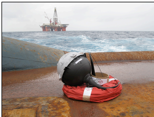
Figura 3: Derivador SVP-WOCE a bordo de embarcação de apoio pronto para o lançamento.
