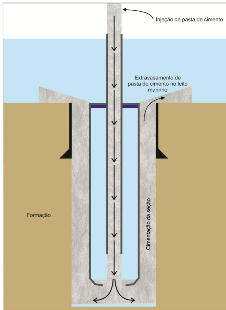
**FIGURA II.11.1.1.5 – Ilustração do extravasamento de pasta de cimento nas fases de início de poço.**
