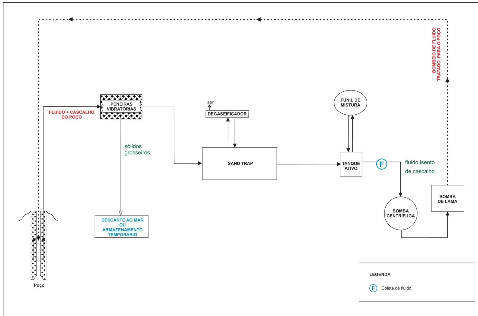
**FIGURA II.11.1.1.3 - Fluxograma do sistema de circulação de fluidos complementares, indicando os pontos de coleta de amostras de fluidos complementares para monitoramento dos parâmetros previstos neste PMFC.**
