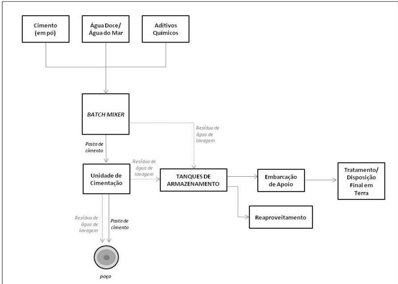
**FIGURA II.11.1.1.7 - Fluxograma do preparo de pasta de cimento em sistema *Batch Mixer*, indicando os resíduos originados.**
