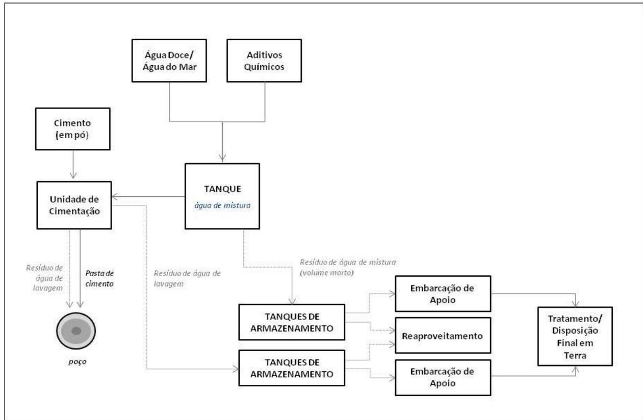
**FIGURA II.11.1.1.4 - Fluxograma do sistema de cimentação, indicando o procedimento de limpeza dos tanques.**
