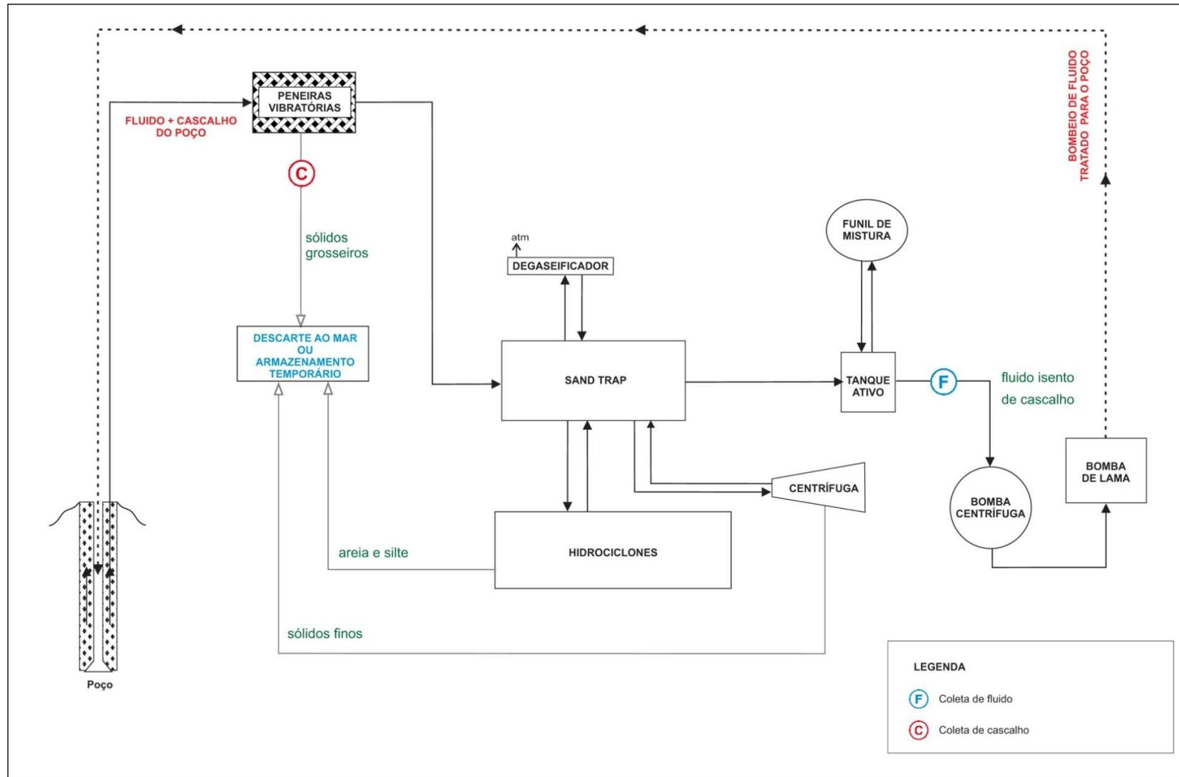
**FIGURA II.11.1.1.1 - Fluxograma do sistema de circulação de FPBA, indicando os pontos de coleta de amostras de fluidos de perfuração e cascalhos para monitoramento dos parâmetros previstos neste PMFC.**
