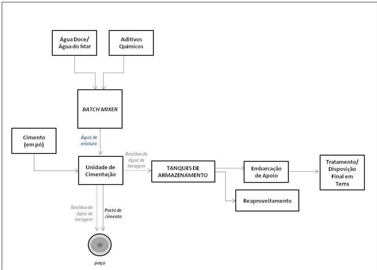
**FIGURA II.11.1.1.8 - Fluxograma do preparo de pasta de cimento em sistema *Batch Mixer* para produção de água de mistura, indicando os resíduos originados.**
