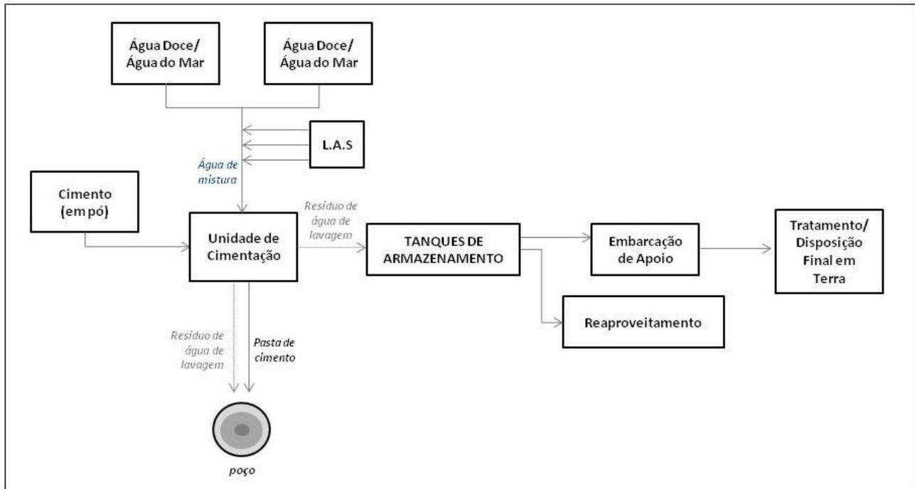
**FIGURA II.11.1.1.9 - Fluxograma do preparo de pasta de cimento em sistema Dosador de Aditivo Líquido (L.A.S.), indicando os resíduos originados.**
