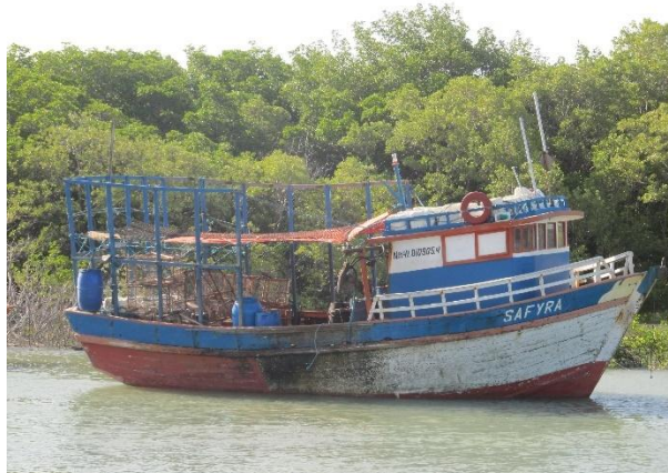
FIGURA II.5.3.4-1 – Embarcação de pesca industrial que opera na modalidade de manzuá direcionada à captura de lagosta no litoral norte do Brasil.
