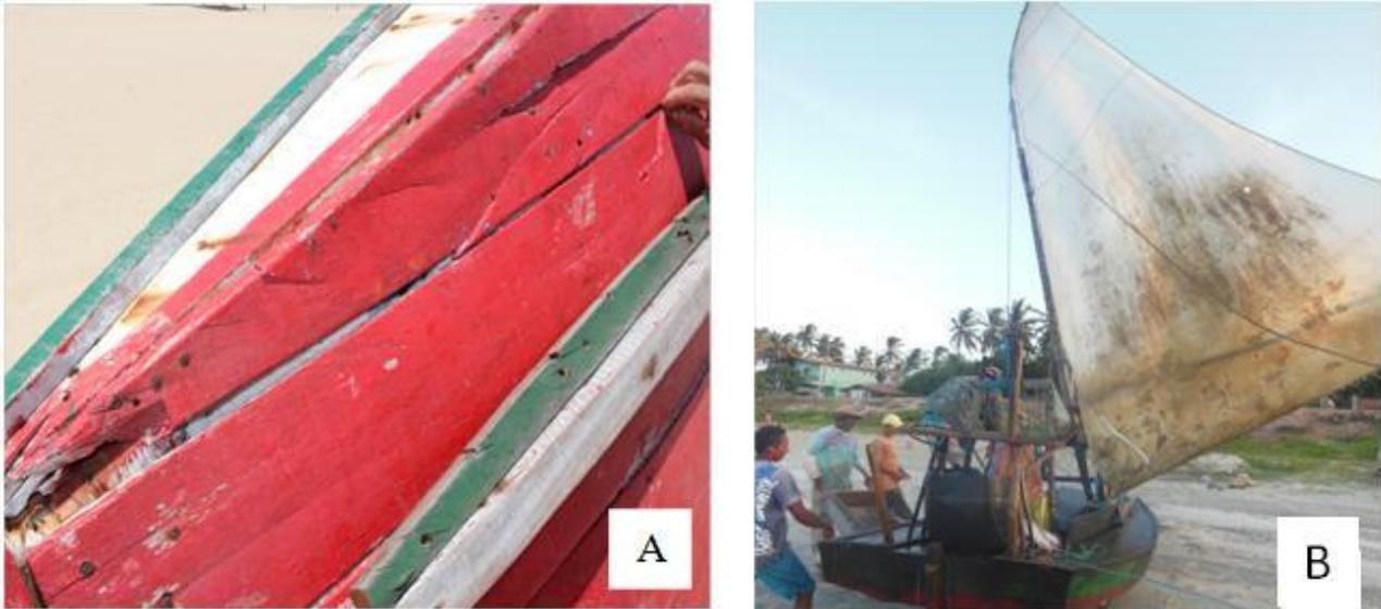
**FIGURA A.3.1 – Estrutura em madeira e isopor de um paquete – imagem A. Jangada – Imagem B.**
