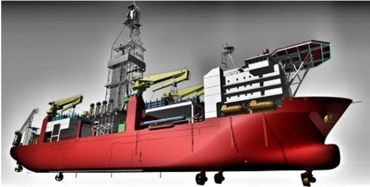
FIGURA II.3.1.8 – Ilustrativo do Sistema de Posicionamento Dinâmico com thrusters azimutais.
