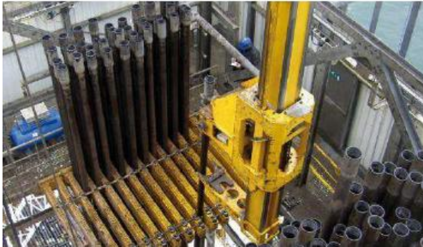
FIGURA II.3.1.2 – Tubos de perfuração organizados em uma sonda marítima.
