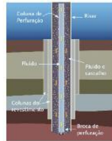
Figura B: Com a instalação do riser, a mistura de fluidos e cascalhos é conduzida à plataforma.
