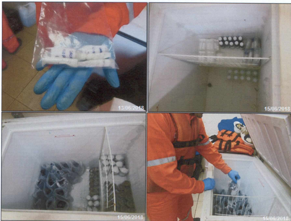
FIGURA 12 – Armazenamento das amostras dos compartimentos água e sedimento durante a Campanha de Caracterização Ambiental da Área Norte de Carcará.
