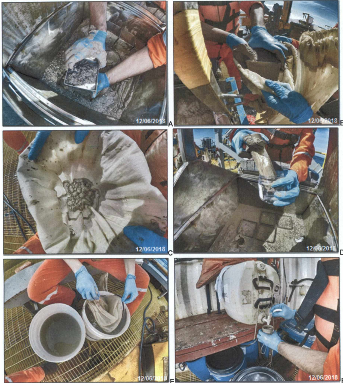
FIGURA 6 – A, B e C) Coleta de sedimento para análise da macrofauna bentônica. D) Amostragem da meiofauna bentônica E) Lavagem das amostras de macrofauna em sacos de nylon com abertura de malha de 0,3 mm, durante a campanha de caracterização ambiental da Área Norte de Carcará.
