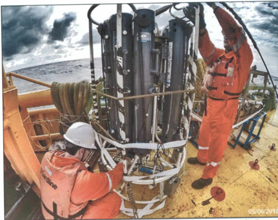
FIGURA 16 – CTD (conductivity, temperature and depth), acoplado à Rosette, utilizado durante a Campanha de Caracterização Ambiental da Área Norte de Carcará.
