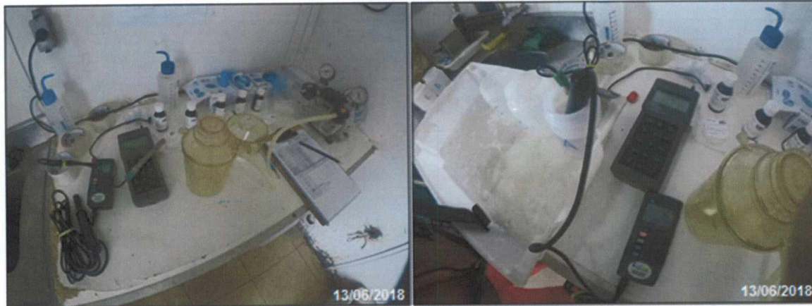
FIGURA 10 – Medição in situ de amostras de água com pHmetro e oxímetro realizada durante a Campanha de Caracterização Ambiental da Área Norte de Carcará.
