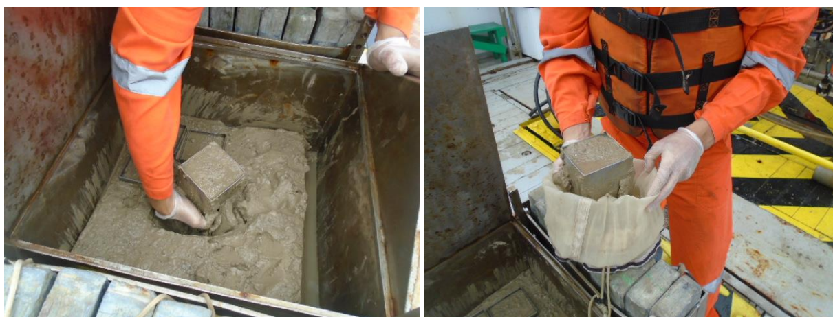
FIGURA 4 – A) Lançamento do boxcorer ; B e C) Exemplos de subamostragens de parâmetros físico-químicos; D) Exemplo de congelamento das amostras destinadas às análises de granulometria, COT, MOT e carbonatos. Campanha de Caracterização Ambiental do Bloco Alto de Cabo Frio Oeste, Bacia de Santos.
