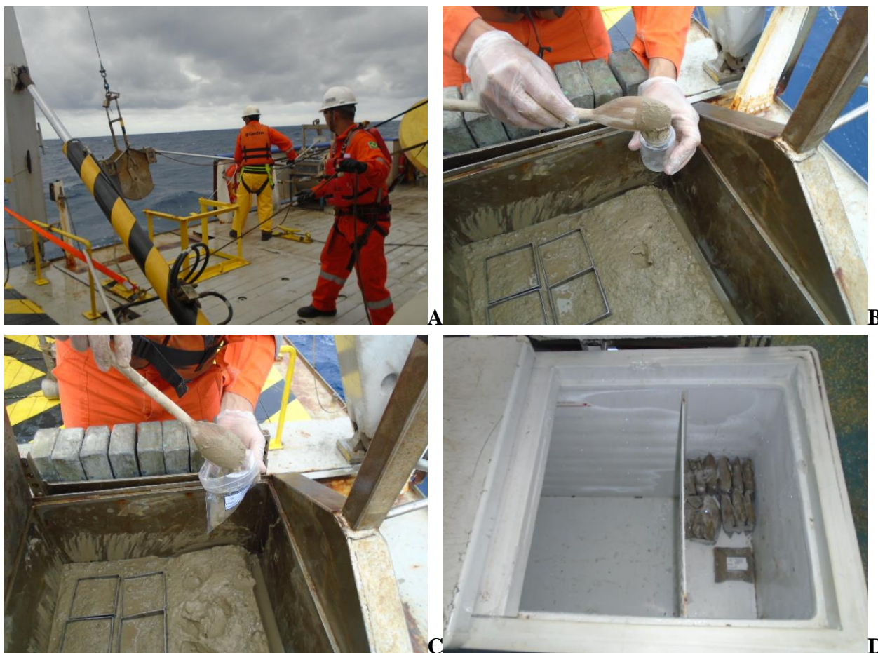
FIGURA 4 – A) Lançamento do boxcorer ; B e C) Exemplos de subamostragens de parâmetros físico-químicos; D) Exemplo de congelamento das amostras destinadas às análises de granulometria, COT, MOT e carbonatos. Campanha de Caracterização Ambiental do Bloco Alto de Cabo Frio Oeste, Bacia de Santos.
