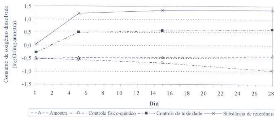
Figura 1 - Consumo líquido de oxigênio dissolvido das soluções preparadas para o Teste de Biodegradabilidade em Água Marinha para o produto FLUIDO DE PERFURAÇÃO BR-MUL - CÓD. 1.10.
