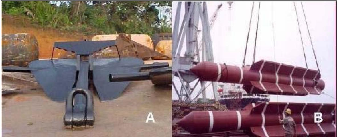
**Figura II.3-3 - Âncora convencional do tipo Stevin (A) e Estaca do tipo torpedo (B).**
