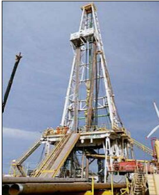
**Figura II.3-5 - Torre de perfuração típica**
