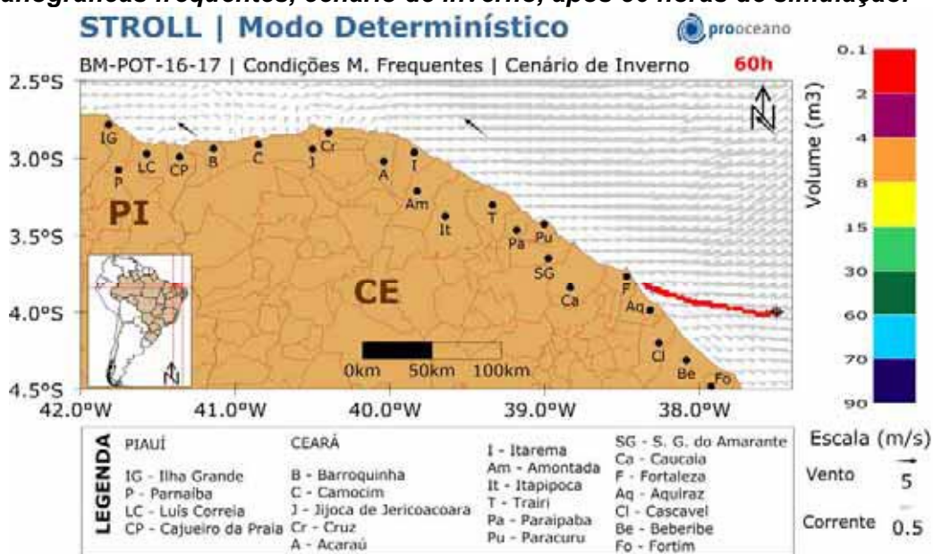
Figura II.6.2.2.5-60 - Resultado da simulação determinística de condições meteo-oceanográficas frequentes, cenário de inverno, após 60 horas de simulação.
