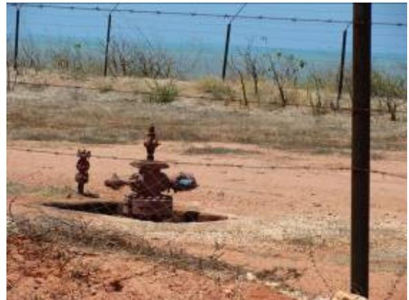
**Figuras II.5.3-13 e II.5.3-14** – Cabeça de poço de petróleo onshore na localidade de Ponta do Mel em Areia Branca – RN.
