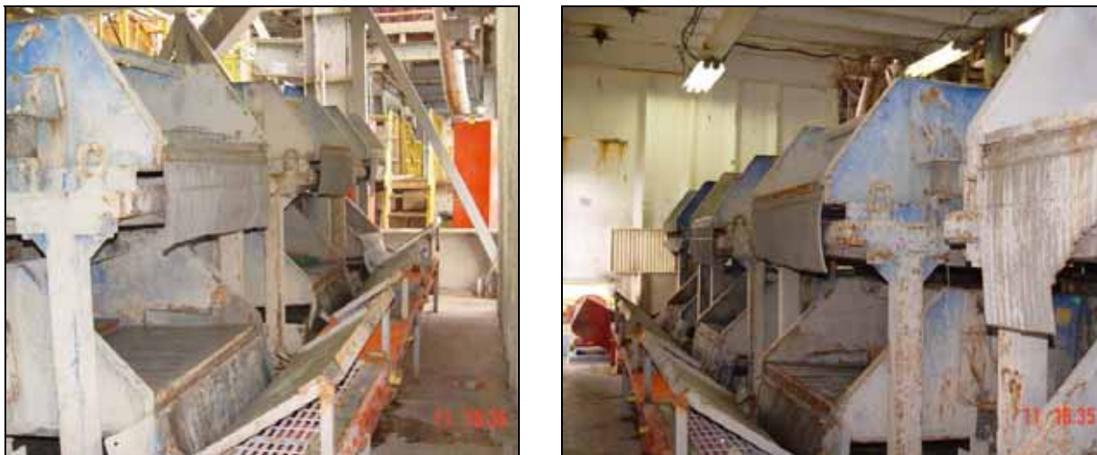
Figura II.3.2-4 – Peneiras utilizadas no tratamento de fluido da unidade de perfuração NS-21.
