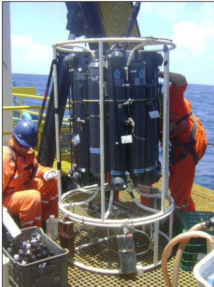
**Figura II.5.1.4.1-2 - Rosette. Equipamento amostrador utilizado para coleta de água. Campanha de caracterização da bacia de Pelotas.**
