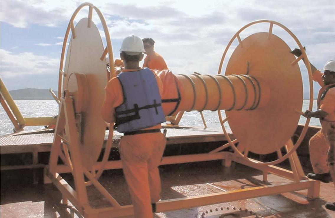
Figura 25 - O lançamento de barreiras de contenção é uma das ações de combate a derramamento de óleo previstas pelo Plano de Emergência Individual
