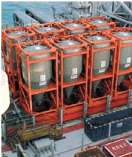
**Figura II.3.10-3 - Armazenamento de cascalho na plataforma**
