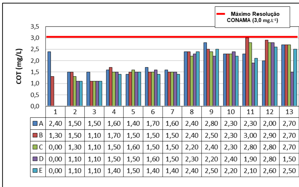
Figura 18: Variação na concentração de COT (mg.L -1 ) ao longo das estações de amostragem na campanha de caracterização da área dos Blocos BM-C-753, BM-C-789, BM-S-536, BM-S-647 e Titã.
