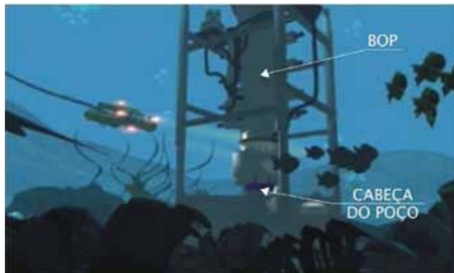
BOP instalado no fundo do mar
