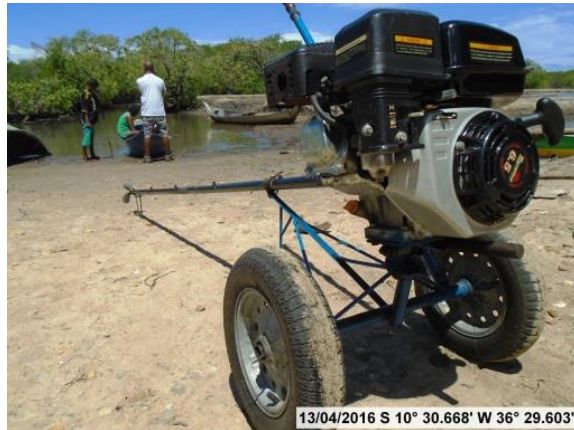
Foto N.E.7.1.1-6 - Motor de rabeta utilizado para embarcações de pequeno porte registrado em Carapitanga, Pacatuba.
