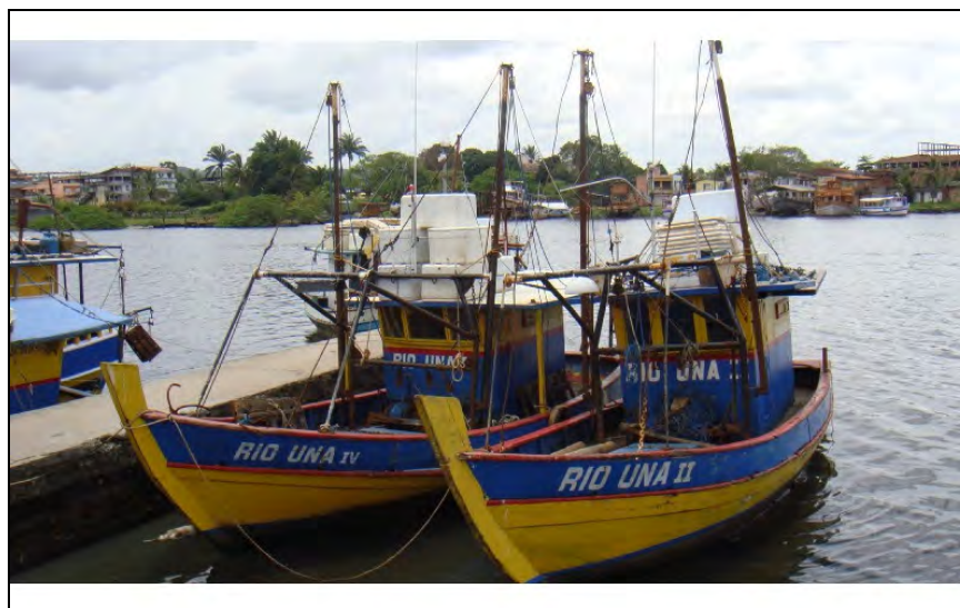
Figura II.5.3- 30 - Barco de arrasto de camarão com “braços” e guincho mecanizados – Bairro do Tento – Valença.
