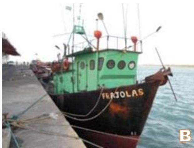
**FIGURA II.6.3.14.1 – Embarcações industriais do Ceará - A: em madeira que opera na modalidade de manzuá; B: em de aço que opera nas modalidades espinhel vertical e linha de mão**
