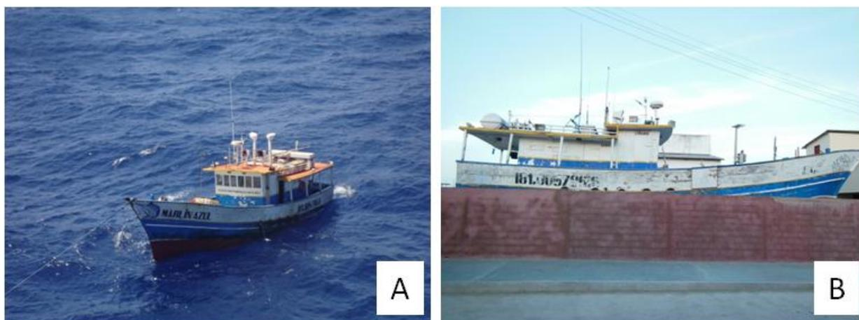
**FIGURA II.6.3.14.6 – Embarcação industrial de madeira para pesca com linha de mão e espinhel horizontal. “A” Embarcação Marlin Azul em Alto Mar e “B” mesma embarcação em estaleiro de Luís Correia**
