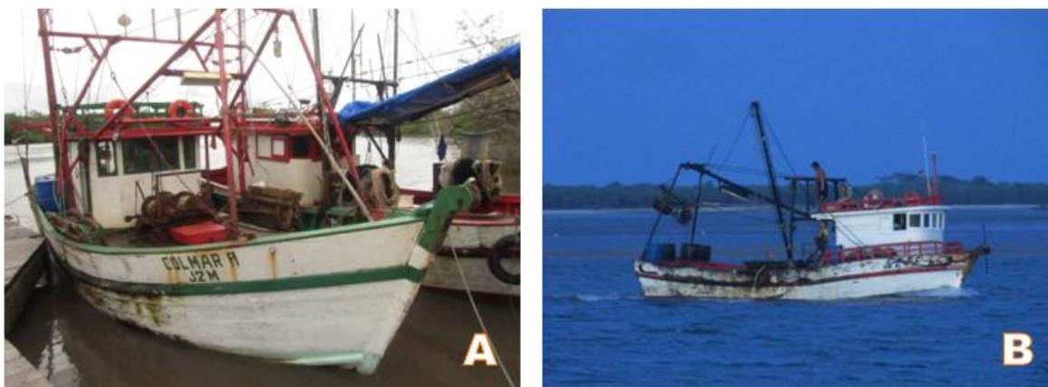
**FIGURA II.6.3.14.7 – Embarcações industriais de arrasto de Tutóia – A: casco de madeira; B: casco de aço**
