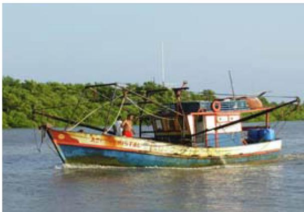
**FIGURA II.6.3.14.5 – Embarcação de arrasto duplo com tangones**
