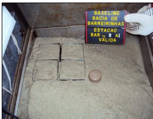
FIGURA II.6.2.10.1 – Exemplo de registro fotográfico do sedimento coletado e dos amostradores da macro e meio fauna bentônica.
