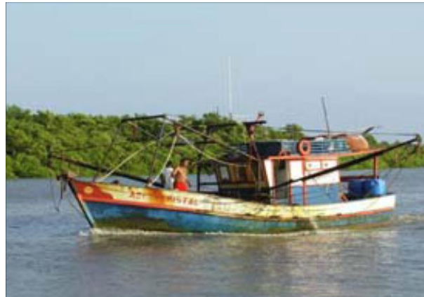
FIGURA II.5.3.8.4 – Embarcação de arrasto duplo com tangones.
