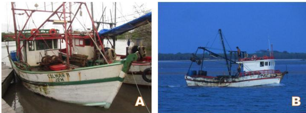
FIGURA II.5.3.8.6 – Embarcações industriais de arrasto de Tutóia – A: casco de madeira; B: casco de aço.
