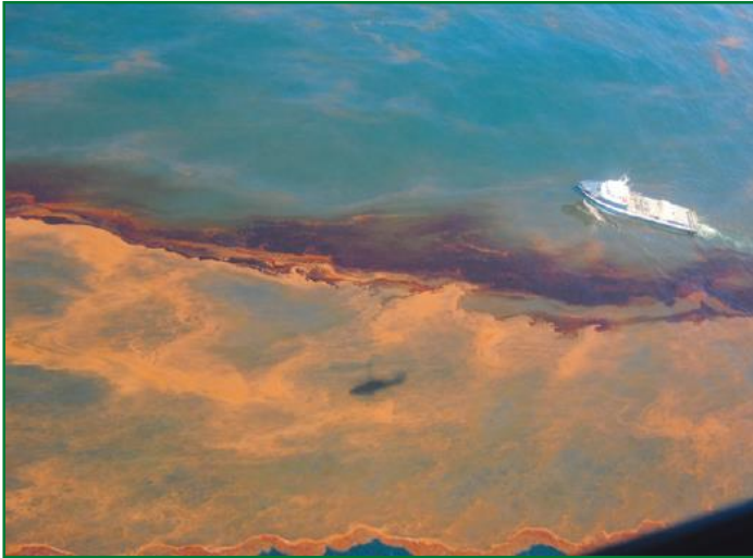
Figura 28: Sub-dosagem – aplicação de menos dispersante que o requerido, significa que a pulverização foi ineficaz. O óleo permanecerá na superfície no seu estado normal (Fonte: OSRL, 2011).
