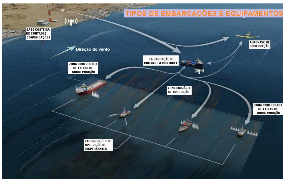
Figura 38: Tipos de navios e equipamentos que podem ser considerados em uma operação de aplicação de dispersante por via marítima (Fonte: Modificado a partir do original em BP, 2012).
