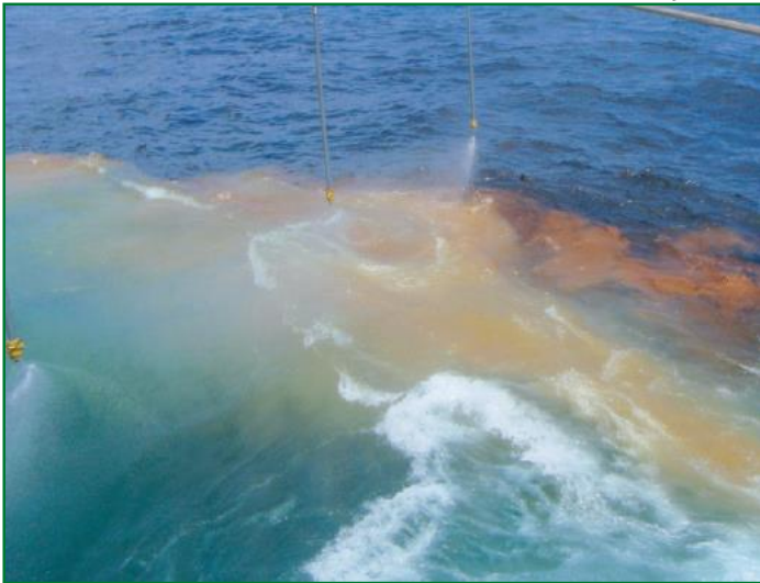
Figura 29: Concentração efetiva – quando o dispersante é eficientemente aplicado, uma pluma colorida na cor cinza ou café será visível na água. Também pode haver um movimento perceptível de óleo na superfície (Fonte: OSRL, 2011).
