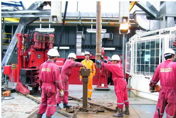
**FIGURA II.3.1.2 – Plataforma com mesa rotativa de uma sonda de perfuração marítima.**
