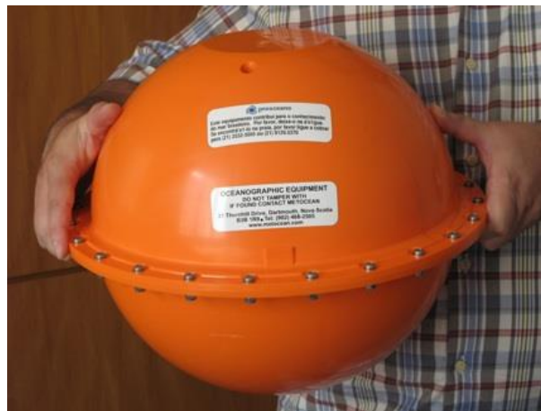
Figura 10: Exemplo de boia de deriva ( drifting buoy ) (Fonte: Prooceano, 2015).
