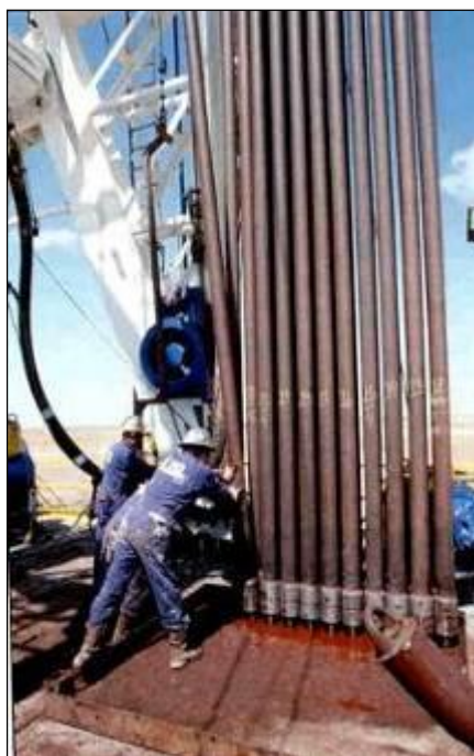
FIGURA II.3.1.2 – Tubos de perfuração sendo organizados em uma Sonda.
