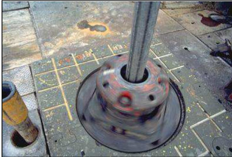
FIGURA II.3.1.3 – Kelly e a mesa rotativa de uma sonda convencional.
