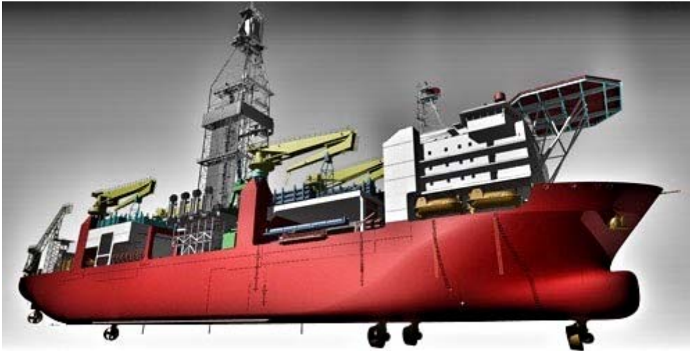
FIGURA II.3.1.7 – Ilustrativo do Sistema de Posicionamento Dinâmico com thrusters azimutais.
