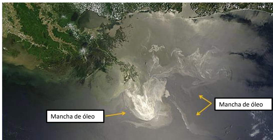
Figura 12: Exemplo de imagem obtida do sensoriamento remoto por satélites (Fonte: NOAA, 2015).
