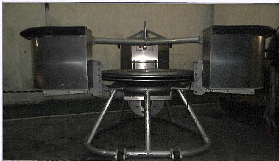
d) Recolhedor LWS 1300 Mecânico – 350m3/h
