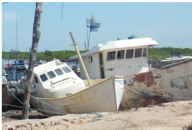
FIGURA II.6.3.6.96 - Exemplo de embarcação com casco de fibra de vidro no Porto do Braga. Fonte: AECOM (2013, 2015).
