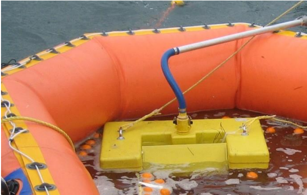
Fig. 33: Um coletor de óleo (skimmer) no separador (Imagem do NOFI Current Buster 2)
