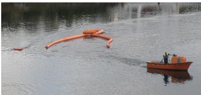
Fig. A10: Girar a bombordo. A guia de barreira de contenção de bombordo Otter se dobra um pouco enquanto o giro está em andamento.
