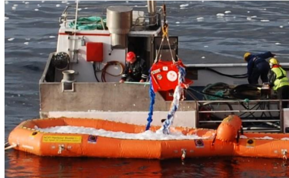
Fig. 34: Coletor de óleo (skimmer) tipo corda oleofílica (rope mop) operando no separador (Imagem do NOFI Current Buster 2)
