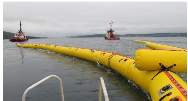
Fig. 31: O NOFI Current Buster 6 em uma configuração de dois barcos durante o teste em Tromsø.
