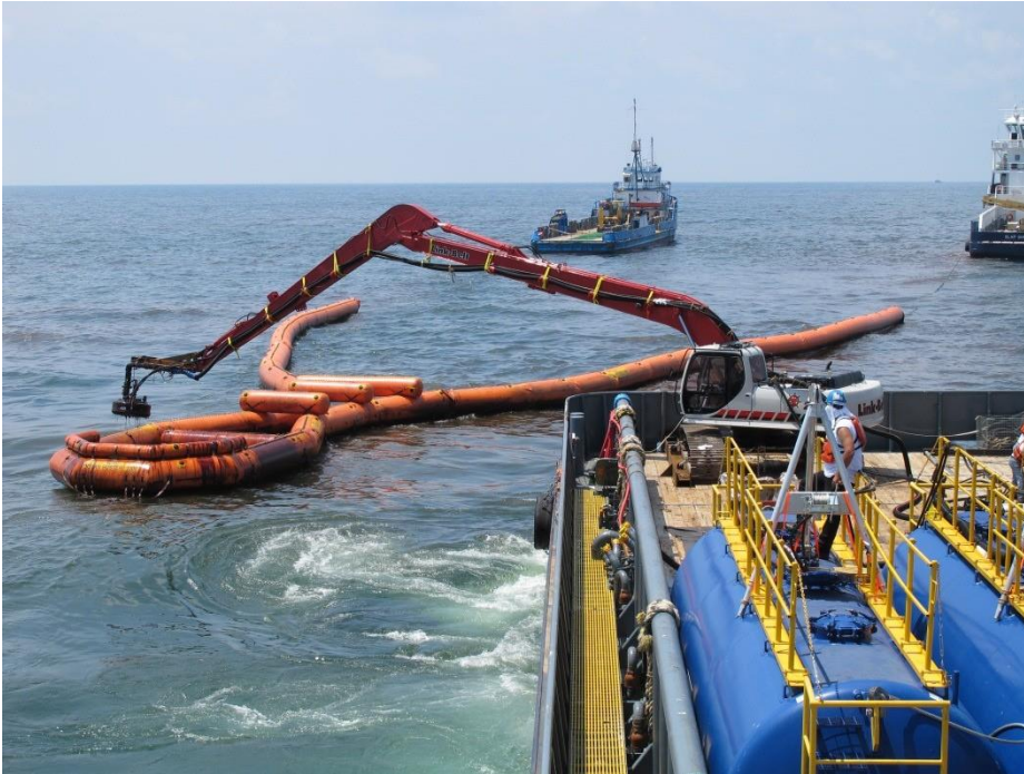
Fig.37: Escavadora com bomba descarregando um NOFI Current Buster 8 durante o derramamento de Macondo em 2010.
