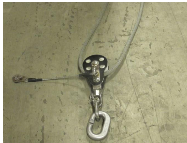
Fig. A06: Visualização detalhada do tirante do BoomVane com bloco e gancho G
