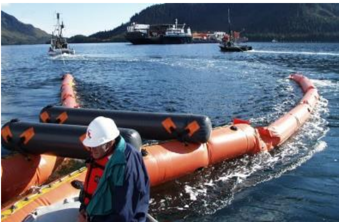
Fig. 38: Girando o sistema em alta velocidade de reboque (Imagem do NOFI Current Buster 4)
