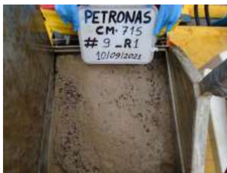
Figura 4: Exemplo de validação e registro fotográfico das amostras válidas de sedimento durante a caracterização ambiental do Bloco C-M-715, Bacia de Campos.
