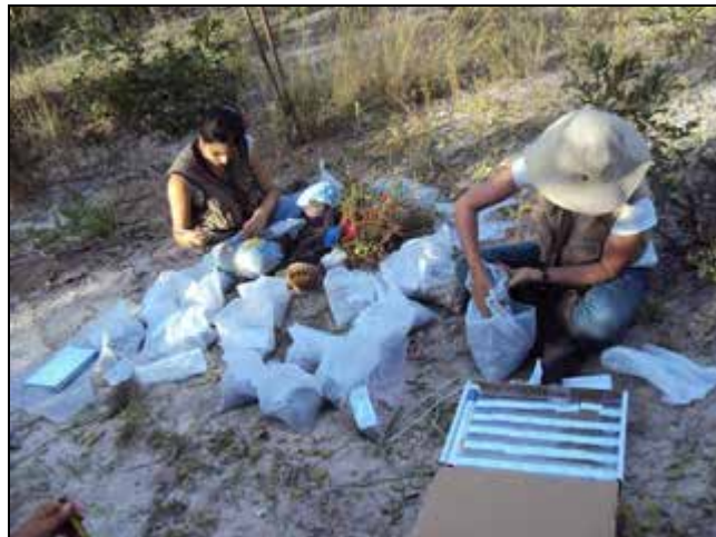
Figura 5.18 - Armazenagem do solo coletado na tradagem.
