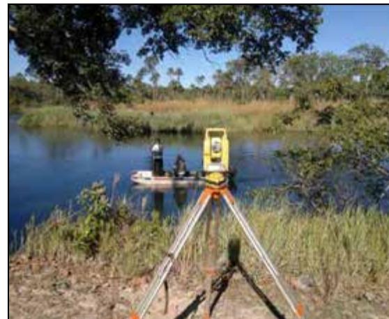
Figura 5.4 – Estação total Topcon, modelo GTS 3000 e 229, utilizada no levantamento batimétrico.
