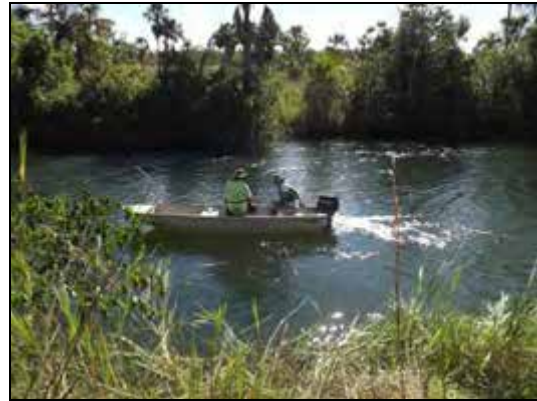
Figura 5.7 – Barco tipo meia chata, com motor de popa de 15 HP.
