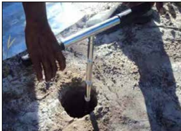
Figura 5.15 - Coleta com trado manual.
