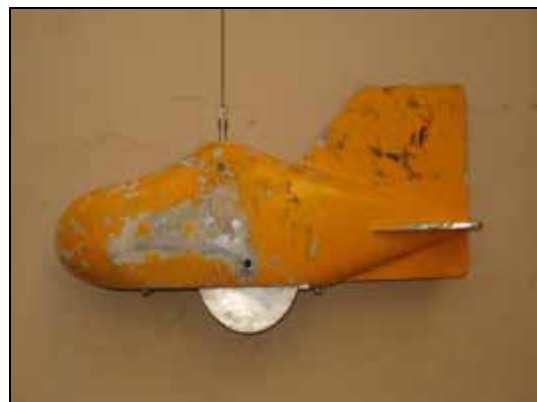
Figura 5.11 – Detalhe do amostrador USBM-60 para sólidos de fundo – vista lateral.
