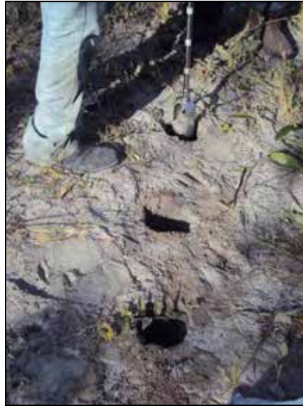
Figura 5.17 - Perfuração de vários buracos para o mesmo perfil de tradagem.
