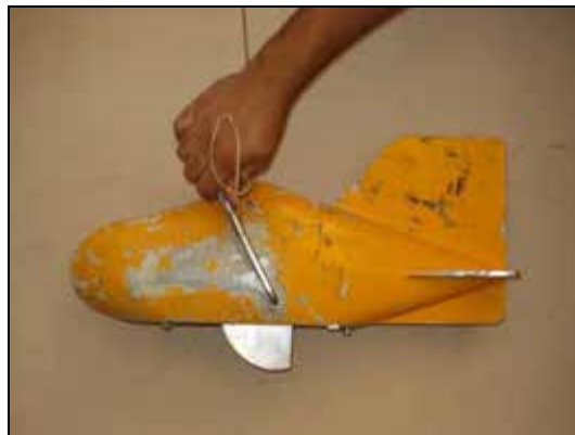
Figura 5.13 – Detalhe do amostrador USBM-60 para sólidos de fundo – vista do recipiente aberto.
