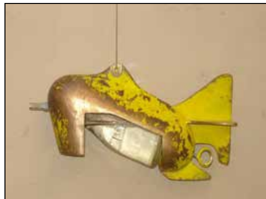
Figura 5.9 – Detalhe de amostrador USDH-59 para sólidos em suspensão – vista lateral.
