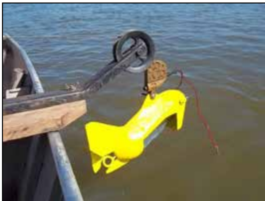
Figura 5.8 – Amostrador USDH-59 para sólidos em suspensão.
