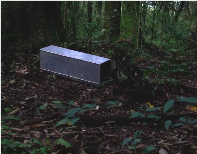
FOTO 75 - ARMADILHA PARA PEQUENOS MAMÍFEROS NÃO-VOADORES (MODELO SHERMANN®) UTILIZADAS PARA O EIA-RIMA DA PCH CABUÍ
