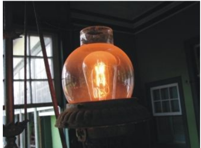
FOTO 320 - LÂMPADA COM FILETES DE CARVÃO ENCONTRADA NA FAZENDA DE BOA ESPERANÇA, BELMIRO BRAGA-MG
