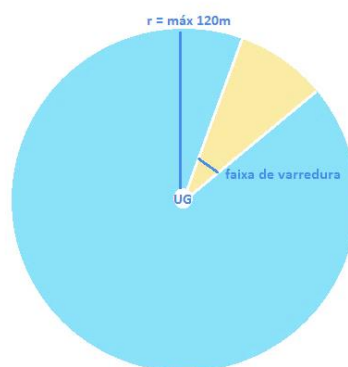
FIGURA 146. Figura ilustrativa do método de busca por carcaças sob as Unidades Geradoras (UG).
