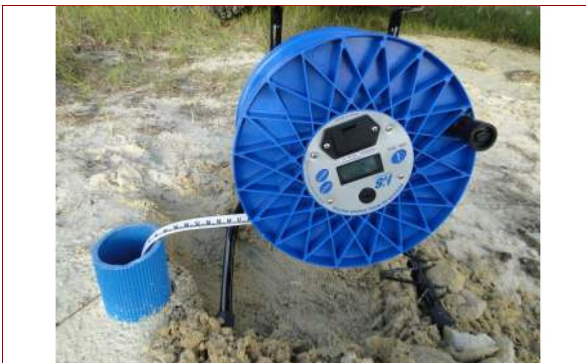
**Figura 1** - Medição do nível do lençol freático com trena eletrônica.
