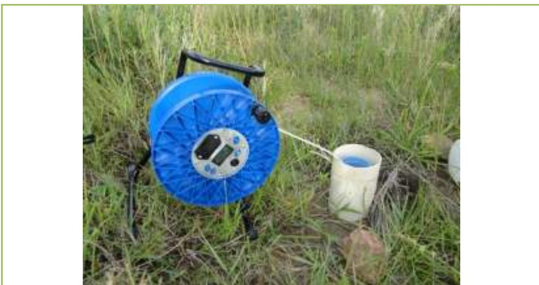
**Figura 3. Trena elétrica a ser utilizada na medição do nível do lençol freático.**
