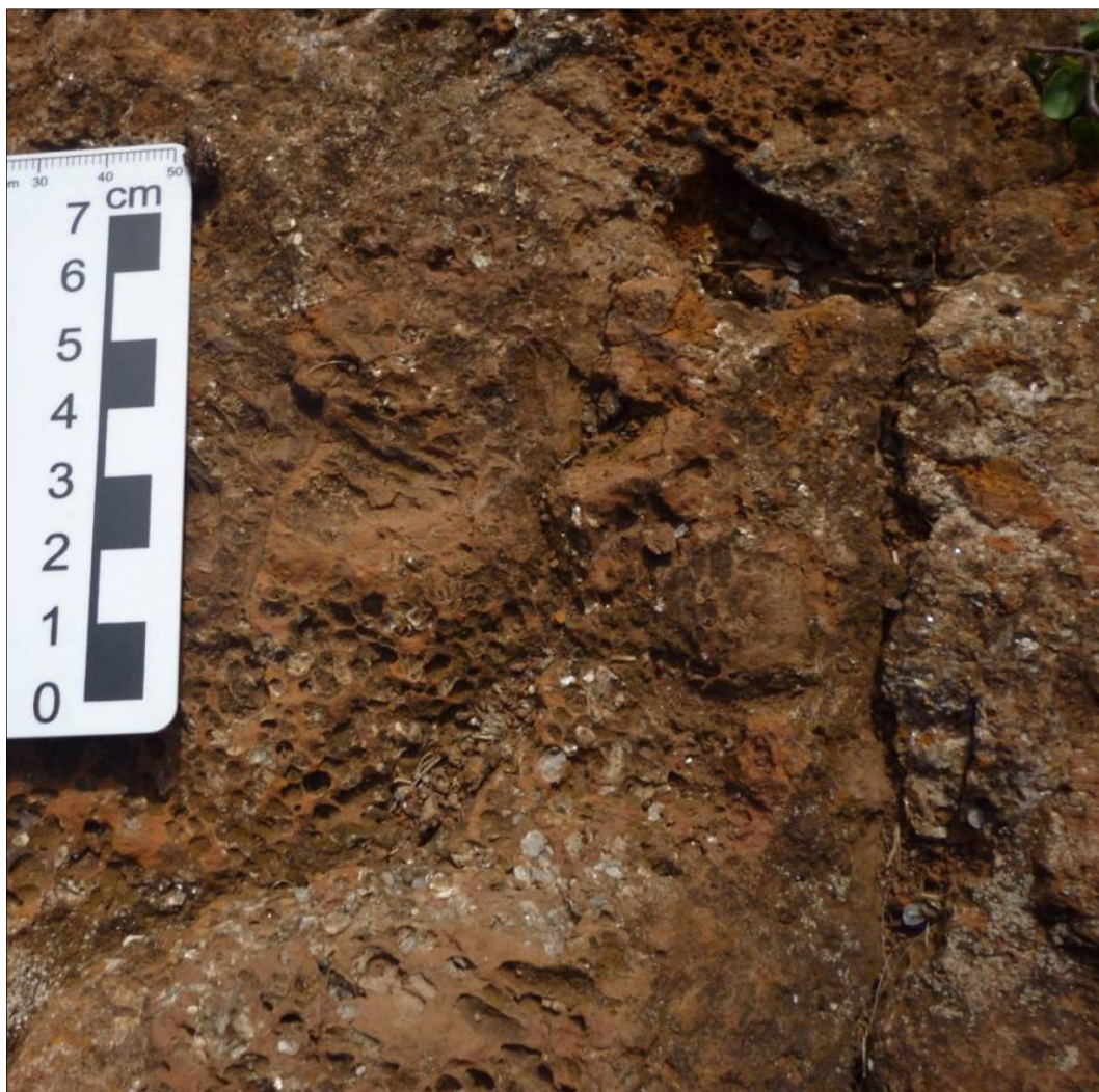
Figura 21 – presença de vesículas e amígdalas de quartzo em ocorrência de litotipo de frente de derrame. (UTM 607546/6561927)
